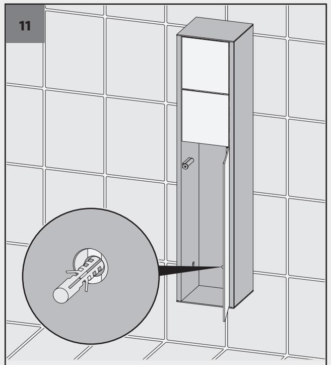
montage aufbauversion · installing mounted version · montage version montable · montage opbouwwitvoering
