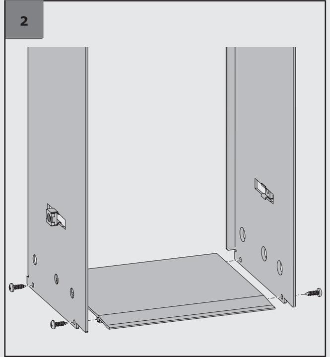
montage - einbaurahmen in vorwandsysteme · installation frame in wall system · montage châssis à monter sur la paroi · montage van inbouwraam in voorzetwand systeem · montage bastidor de montaje en sistemas de tabiques
